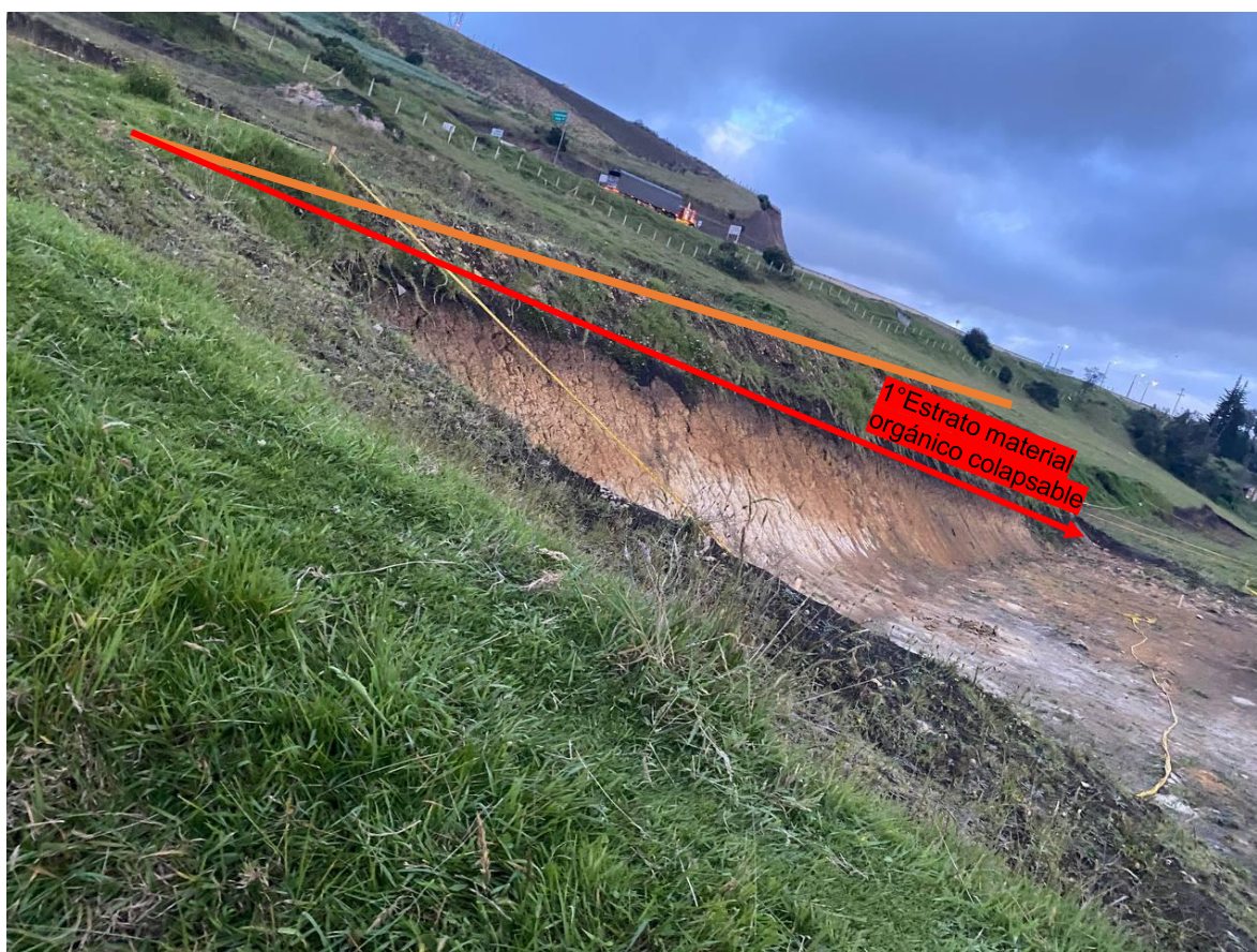
Imagen 9. Foto de campo que indica el buzamiento (inclinación de los estratos).
