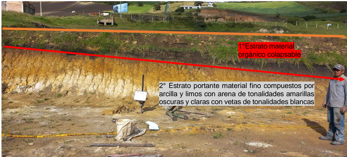
Imagen 10. Foto de campo que indica el buzamiento (inclinación de los estratos) longitudinalmente sentido norte este.
