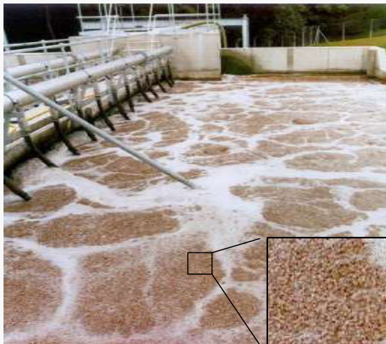
Fig 1. Imagen de un reactor MBBR abierto y caldo de nutrientes (Agua residual)
